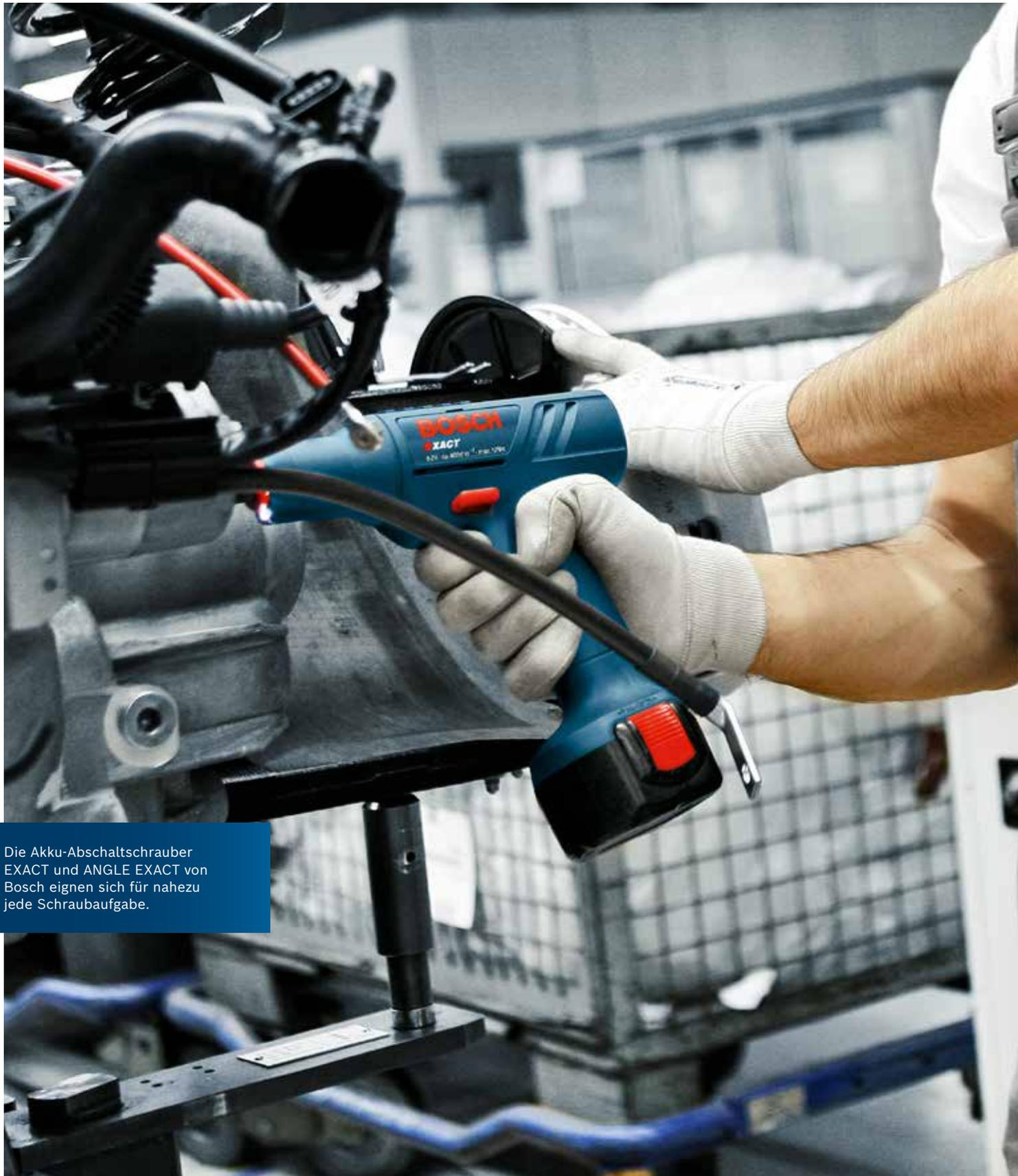
Die Akku-Abschalterschrauber EXACT und ANGLE EXACT von Bosch eignen sich für nahezu jede Schraubaufgabe.
