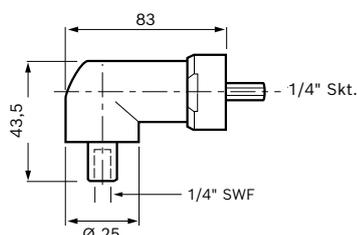
**0 607 451 618** Abmessungen in mm
