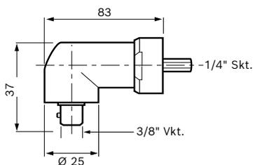
**0 607 453 630** Abmessungen in mm
