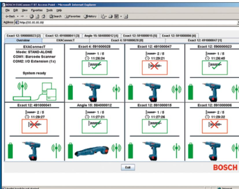
Durch Klicken auf die Registerkarte 'EXAConnect' werden detaillierte Daten für bis zu sieben BT-EXACT Schrauber in Echtzeit angezeigt. Das System liefert zahlreiche Daten, z.B. BT-EXACT Schraubename, Datum, Uhrzeit, Schraubzeit, Drehrichtung, Fehlermeldungen, Arbeitsfortschritt und zusätzliche Eingabedaten (wie Barcodes oder laufende Nummern).
