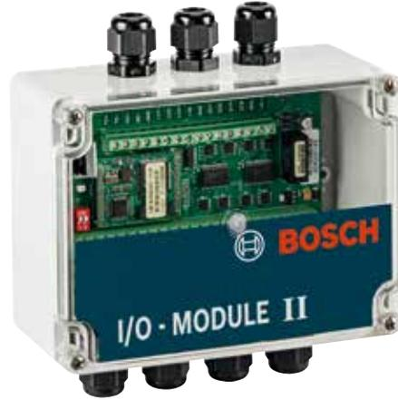
Das digitale I/O-Modul bezieht seine Spannung von der EXAConnect Steuerung und empfängt Schraubdaten über die RS-422-Schnittstelle der Steuerung. Das Modul hat jeweils 16 Ein- und Ausgänge für den Datenaustausch mit einer SPS. Die Konfiguration erfolgt über die EXAConnect Software (in einem Web Browser).
