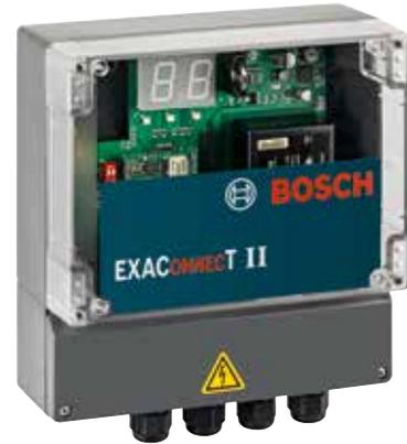
Die Steuerung EXAConnect ist das Bindeglied zwischen Ihrem Prozessnetzwerk und dem über Bluetooth angebotenen BT-EXACT Akku-Schrauber. Informationen über den Verschraubungsprozess können bidirektional in Echtzeit ausgetauscht werden, um sicherzustellen, dass jeder BT-EXACT Akku-Schrauber genau weiß, was er wann zu tun hat. Eine EXAConnect Steuerung kann sieben BT-EXACT Schrauber gleichzeitig steuern und ist damit im Vergleich zu anderen Systemen sehr kostengünstig.
