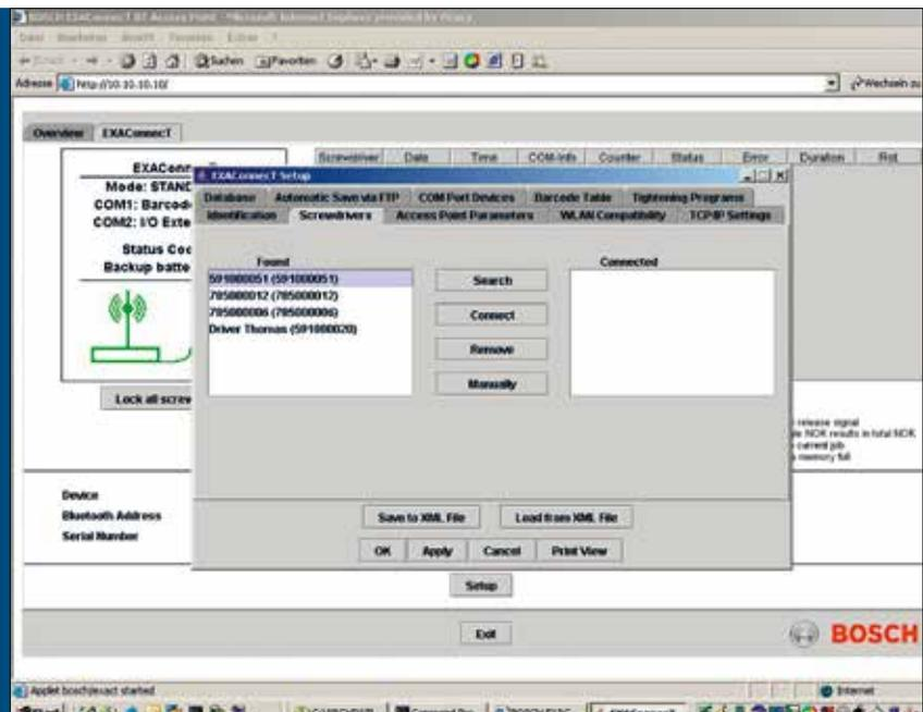
Das links gezeigte Menü zur Schrauberkonfiguration steuert alle Funktionen vom Schrauben zählen über die Nacharbeitsstrategie bis zu den Auswahlmöglichkeiten für die Datenausgabe. BT-EXACT Schrauber und EXAConnect Steuerung sind so konfigurierbar, dass Daten von einer Vielzahl von Systemen gesendet und empfangen werden, z.B. Ethernet-Leitsysteme, SPS, Barcode-scanner oder unser digitales I/O-Modul.
